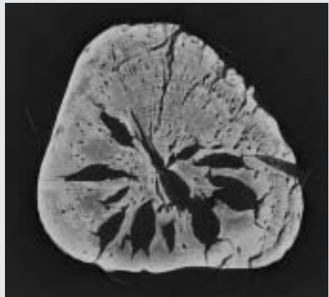
図3 十分な含浸が行われなかった出土木材のCT画像 低分子量の含浸強化剤は木材中に拡散・浸透しやすいといわれているが、十分な含浸が行われずに短期間で処理したものは、外形をよく保持しているものの、内部に深刻な破壊が生じている。木材の劣化状態、樹種、大きさ、木取りなどを考慮して、保存処理法を選択し、十分な含浸期間を設定する必要がある。
